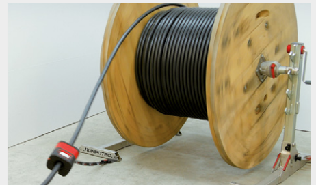
RM35 mit RUNPOLIFTER L1600 und 3 x 35 mm 2 Kabel RM35 with RUNPOLIFTER L1600 and 3 x 35 mm 2 cable
