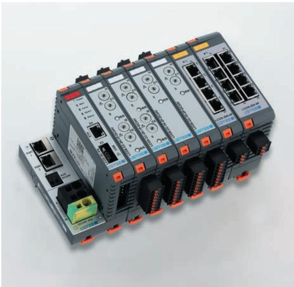
LCOS System mit Einspeisung, Buskoppler, LCOS-CCI und Switches
